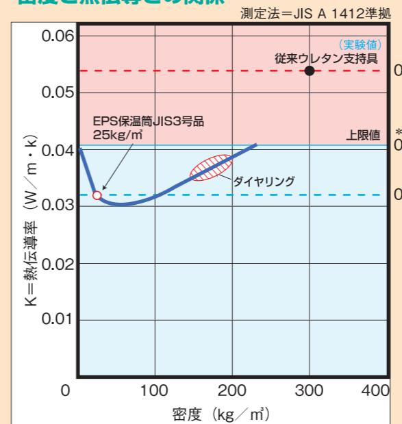
\*5°C冷水・冷温水配管、管径200mm、表面熱伝導率BW/m·k、外気温30°C外気相対温度85%の条件にて保温厚さ40mm時表面結露しない最高の熱伝導率。
